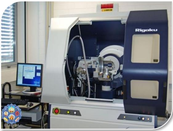
для проведения фундаментальных и прикладных экспериментальных исследований, решения технических и научно-исследовательских задач в области инженерного материаловедения с применением современных методик получения и обработки рентгеновских дифракционных данных, реализованных на дифрактометре Ultima IV для получения прямой, точной, достоверной и многогранной информации о фазовом составе и структуре
